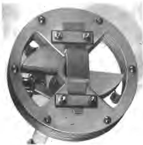
Fig. 15 - Interno di un ondametro ad assorbimento con circuito a «farfalla» per frequenze da 200 a 1250 MHz.
