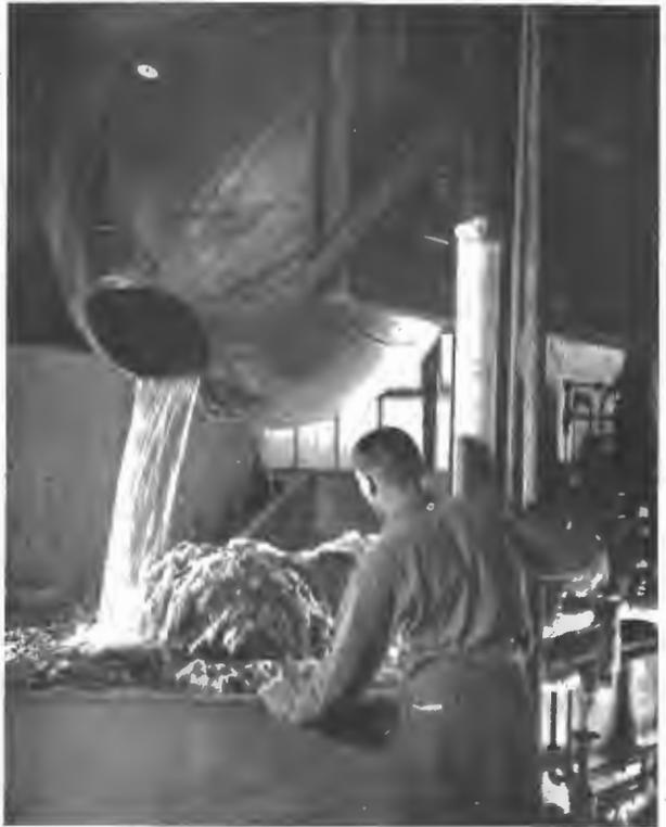
Fig. 3 - Bollitore sferico da laboratorio e lavatoio.
