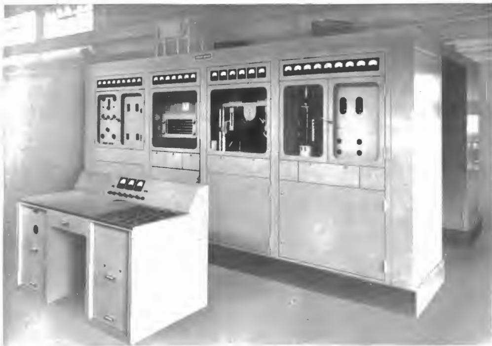
Fig. 1. - **Trasmettitore a onde corte universale semi-automatico, da 10 kW in telefonia tipo SO 25/10 K.** Gamma della lunghezza d'onda 12,5-90 m. Durata del cambiamento della lunghezza d'onda: 3 minuti. Il trasmettitore può essere messo in servizio dal pulpito di comando. I singoli armadi contengono da sinistra a destra:
