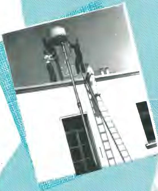
Il nostro direttore e l'ing. Dobner esaminano l'antenna rotante di un radar su 10 cm. È visibile l'uscita del guida onde nel fuoco del paraboloide riflettore.
