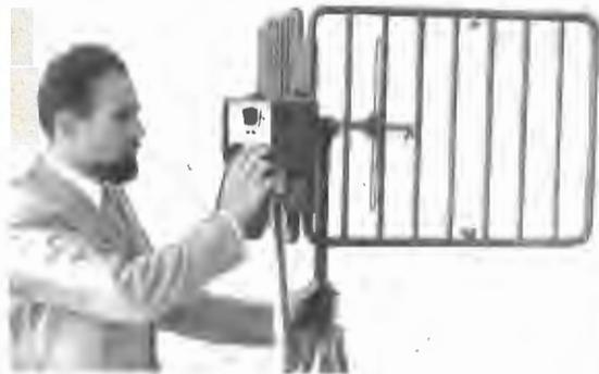
L'ing. Gaiani col ricetrasmittitore ad onde decimetriche della Brown-Boveri. Si noti l'antenna nel fuoco del riflettore.
