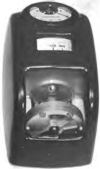
Fig. 18 - Oscillatore per o.u.c. General Radio tipo 887A.
