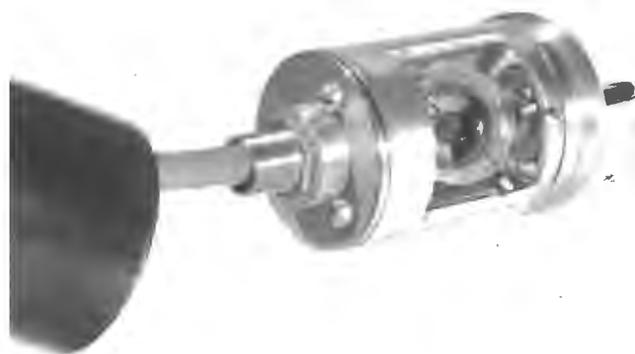
Fig. 11. - Testa di voltmetro a diodo per frequenze elevate. Il diodo a ghianda è montato con un angolo tale da assicurare collegamenti molto corti con il condensatore (del tipo a bottone) e con la massa schermante.
