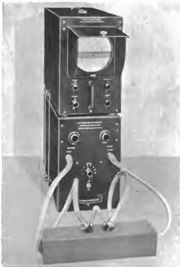
Fig. 9 - Aspetto esterno del metalloscopio elettronico Mark II B.
