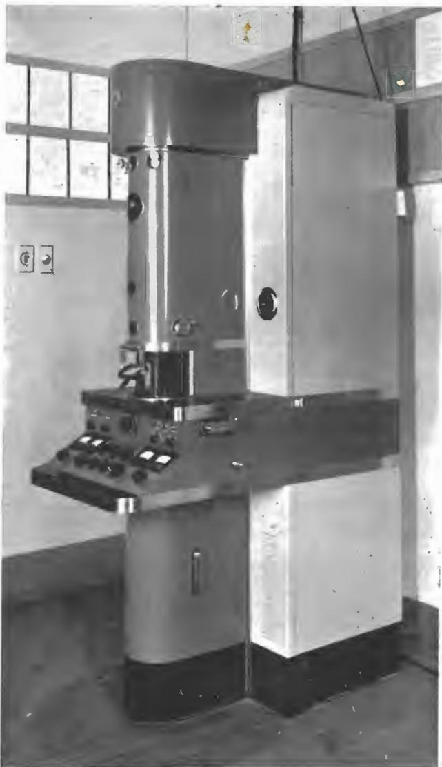
Fig. 3. - Grande microscopio elettronico RCA mod. E.M.U.. Un esemplare di questo tipo è attualmente in funzione anche in Italia nell'Istituto Scientifico della Montecatini.
