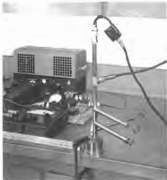
Fig. 2 - Disposizione tipico di un bolometro a linee nella determinazione della tensione di uscita di un generatore di segnali campione.
