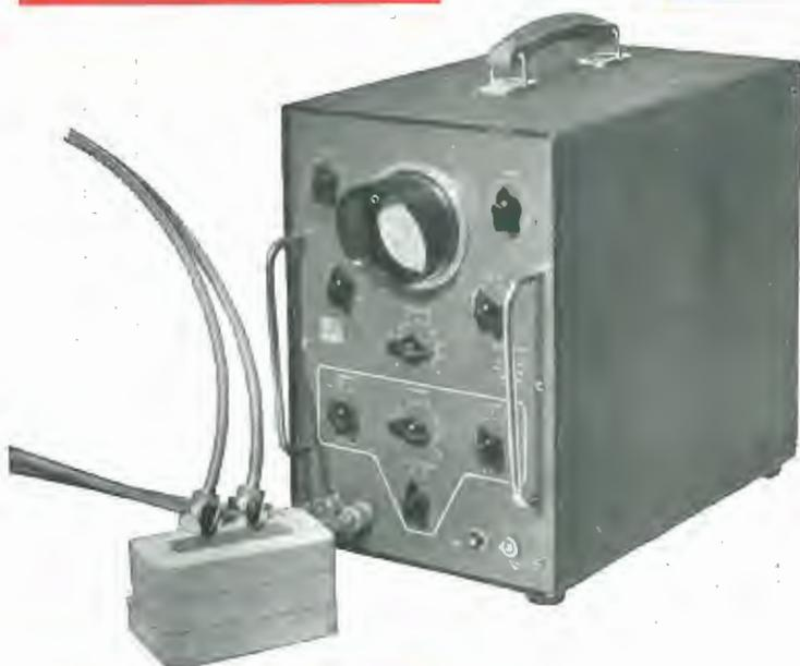
**Metalloscopio a Ultrasuoni
