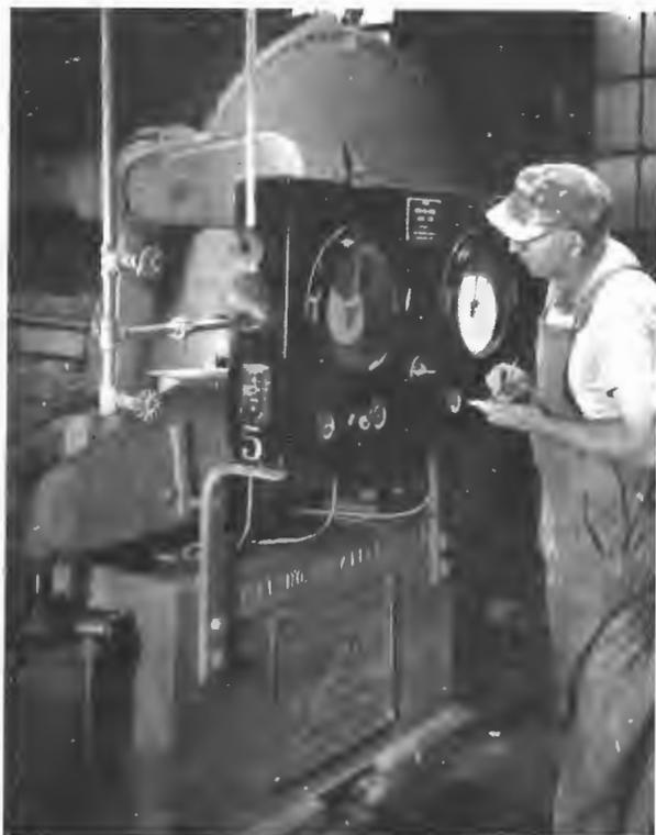
Fig 5 - L'azione delle battitrici è individualmente registrata da strumenti.
