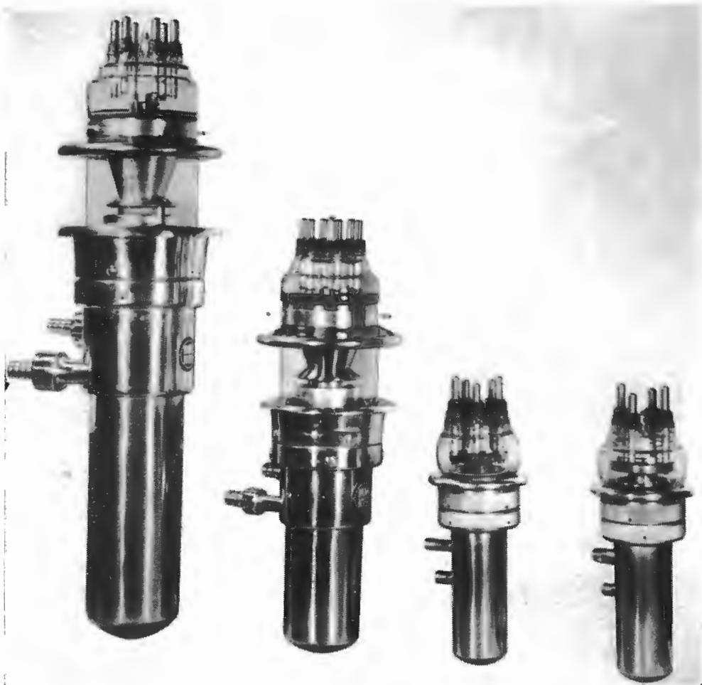
nei circuiti di antenna si ottiene quindi una potenza irradiata di 120 kW. La potenza anodica dissipata dai due tubi è di 52 kW in regime di portante, il che corrisponde ad un rendimento del 30 %. Questo elevato rendimento dello stadio finale permette di costruire i grandi trasmettitori moderni modulati in classe C il cui rendimento globale è dell'ordine del 40 %.
