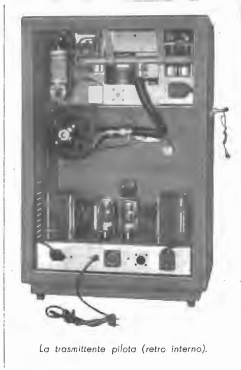
La trasmittente pilota (retro interno).
