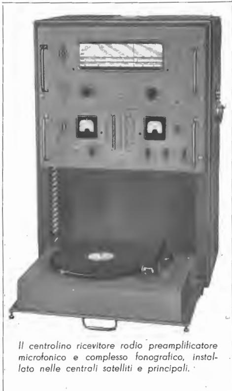
Il centralino ricevitore radio preamplificatore microfonico e complesso fonografico, installato nelle centrali satelliti e principali.
