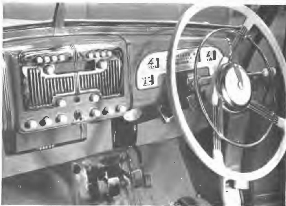
*Installazione di ricevitore radiomobile H M V a onde predisposte.*
