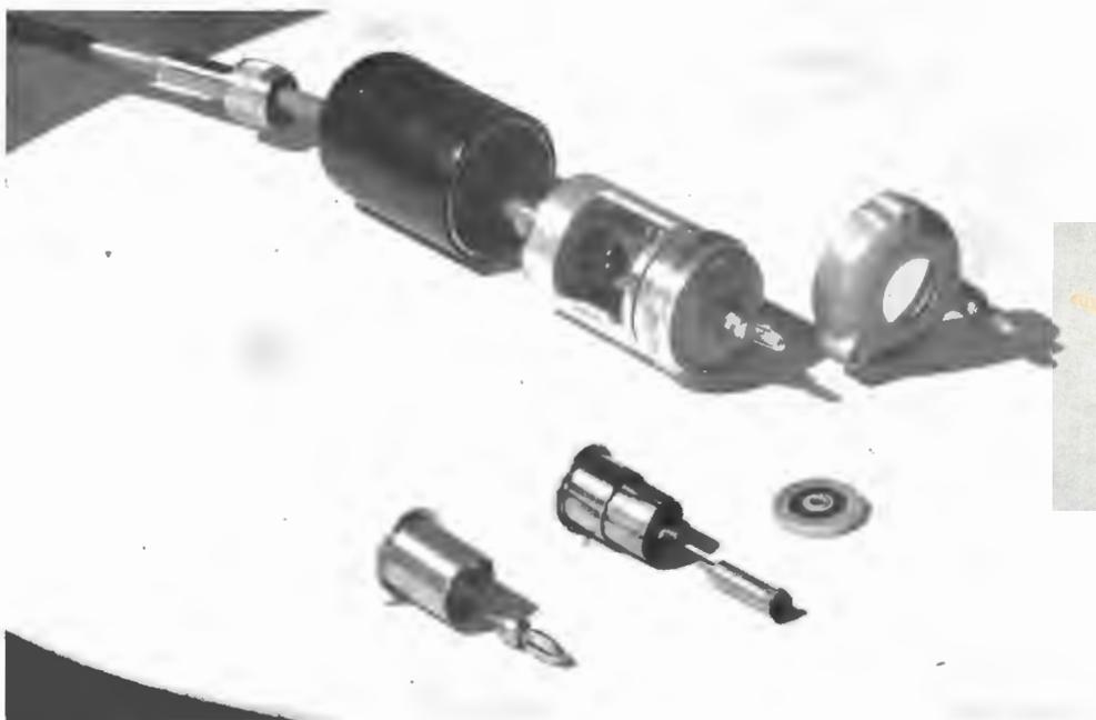
Fig. 22. - Testa di un moderno voltmetro di cresta a diodo smontata.
